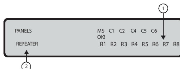
Figuur 22: Netwerkelementen bekijken (MFI-modules, repeaters en client-centrales)
