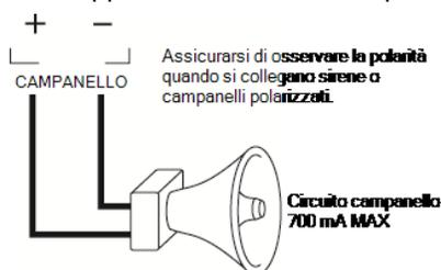
**Fig. 3-10 Cablaggio campana**
