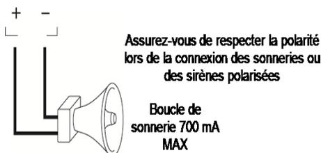
**Figure 3-10** Câblage de sonnerie
