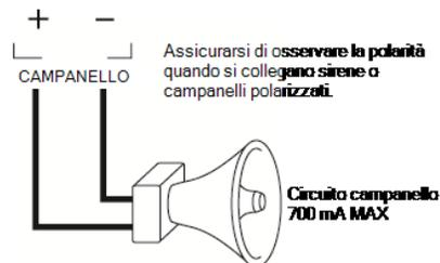
**Fig. 1-5 Cablaggio campana**
