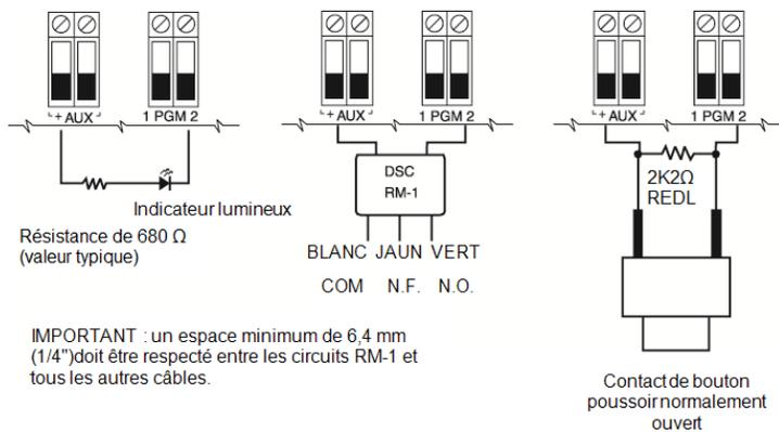
**Figure 1-7 Sortie LED à résistance de limitation de courant et sortie à étage de relais facultative.**
