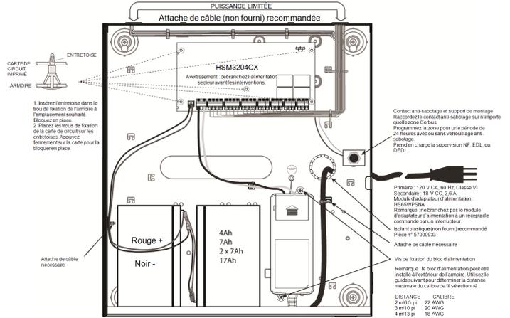
Figure 1-4 HSM3204CX/ HSM3408 dans l'armoire HSC3010C.
