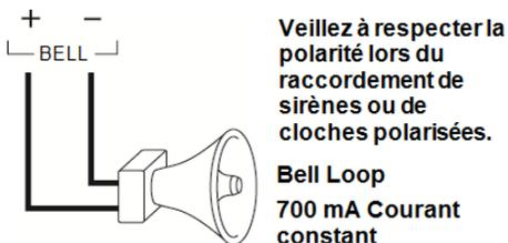
Figure 1-11 Câblage de sonnerie
