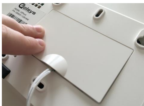
Duw het deksel omlaag totdat dit vastklikt.
