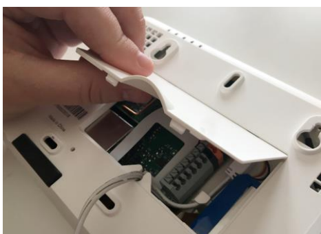
Steek de bovenkant van het deksel in de achterkant van het paneel.
