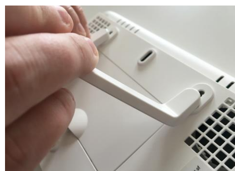
Steek de tafelstandaard in de montagegaten en duw de standaard omhoog totdat hij vastklikt.
