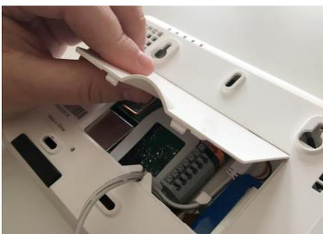
Platzieren Sie die Oberseite der Abdeckung auf der hinteren Abdeckung der Zentrale.
