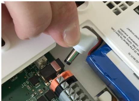
Schließen Sie das Stromkabel an.
