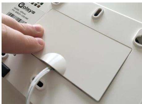
Klappen Sie die Abdeckung nach unten, bis sie einrastet.
