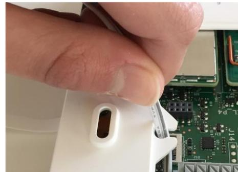
Schieben Sie das Kabel hinter die Zugentlastung.
