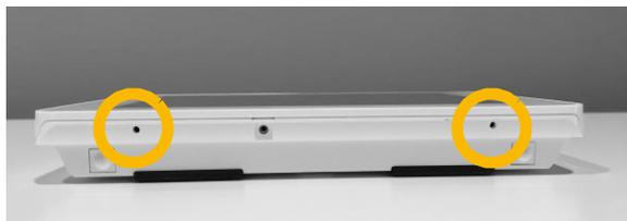
Die Mikrofone befinden sich an der Unterseite der Zentrale.
