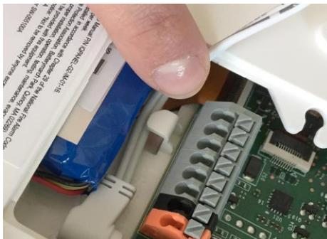
Verlegen Sie das Kabel hinter der Halteklemme.
