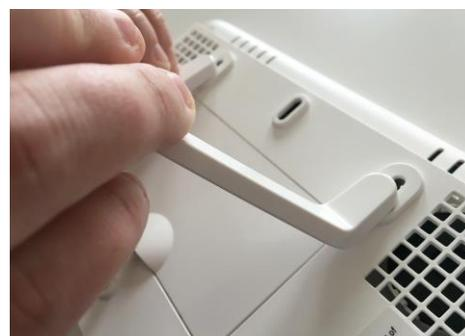
Setzen Sie den Standfuß in die Befestigungsbohrungen, und drücken Sie ihn nach oben, bis er einrastet.
